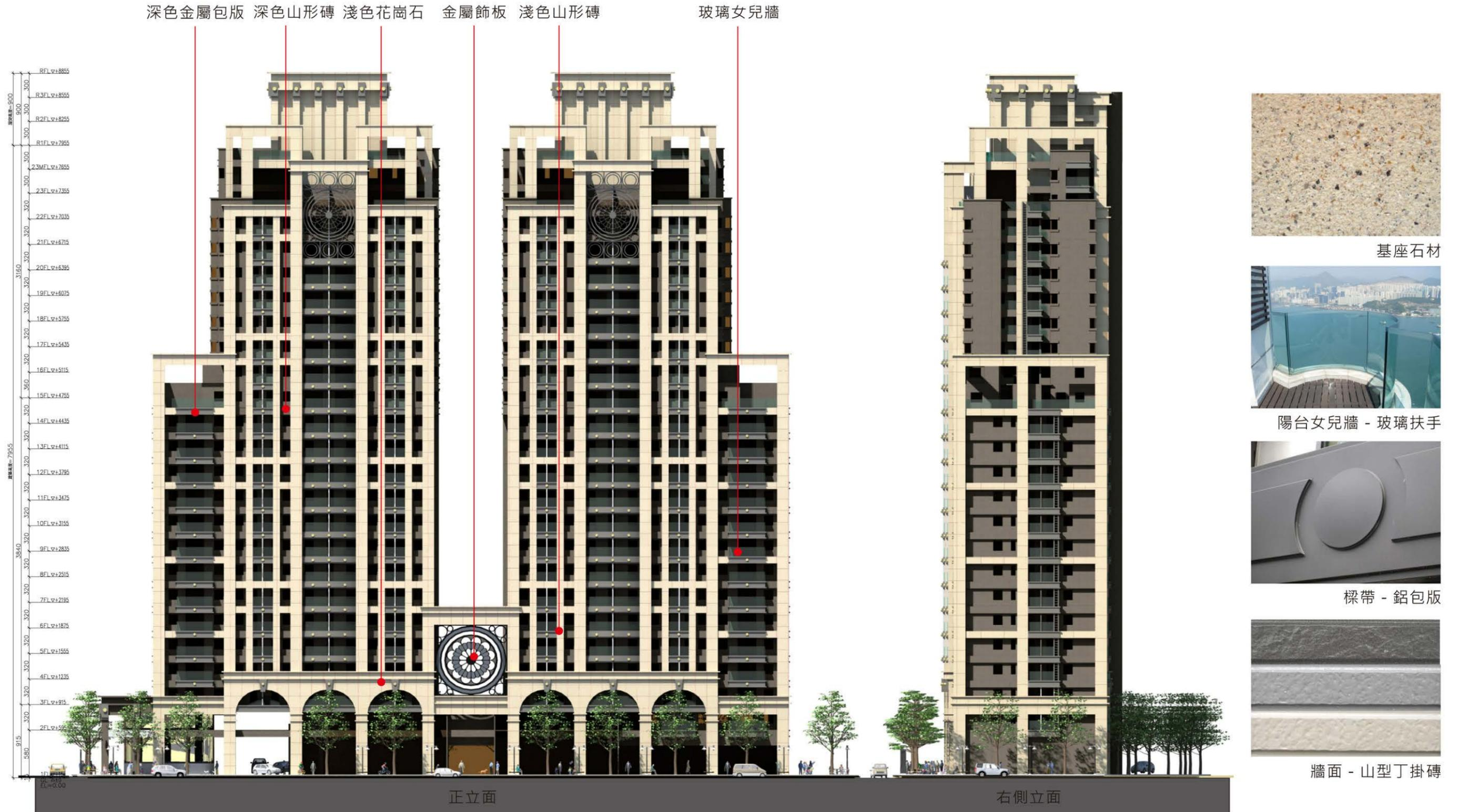
圖 12-2 建築量體立面材質及色彩示意圖(一)
