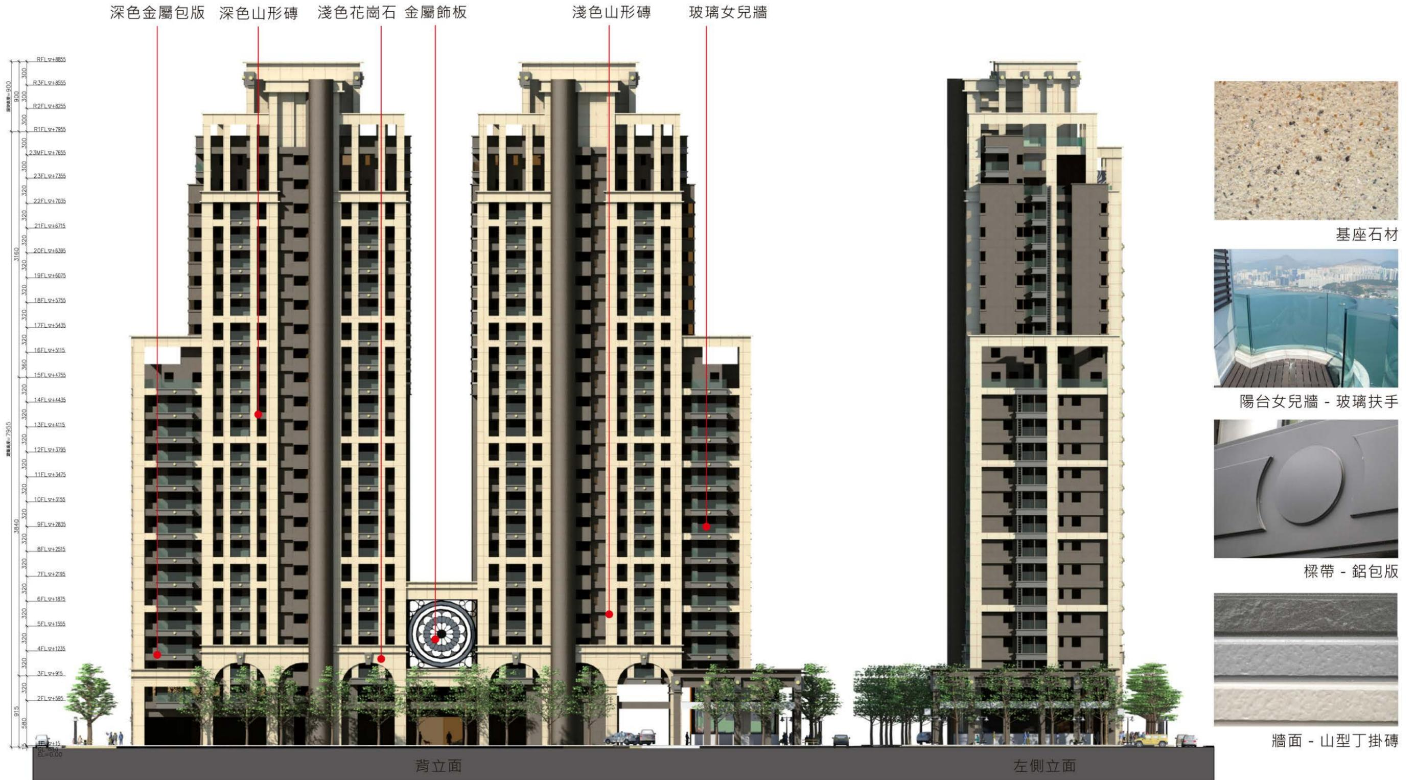
圖 12-3 建築量體立面材質及色彩示意圖(二)
